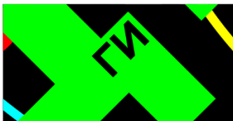
Недифракционный микротекст «ГИ», высота символов 100 \pm 10 мкм
